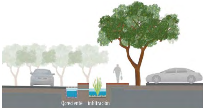
encauzamiento de escurrimientos y captación y de agua pluvial en vialidad
